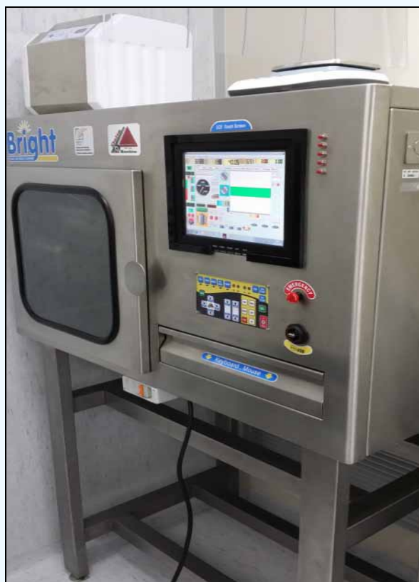
Fig. 1.3 - Apparecchiatura per il taglio robotizzato dell'osso
